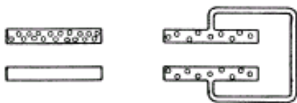
3. ábra. Kondenzátor megtöltött és kisütött állapotban.
